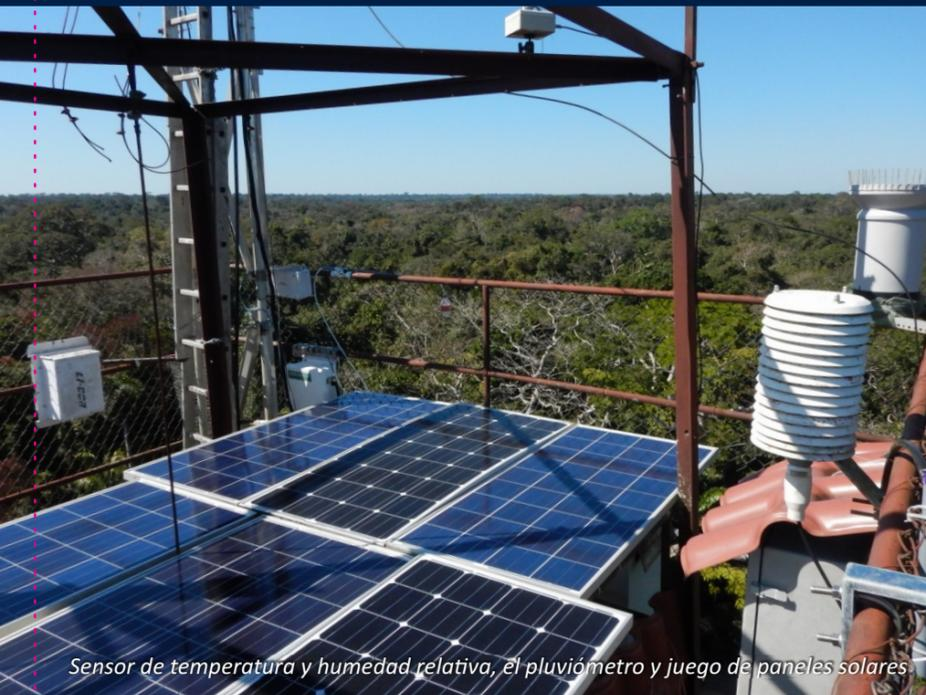
Sensor de temperatura y humedad relativa, el pluviómetro y juego de paneles solares
