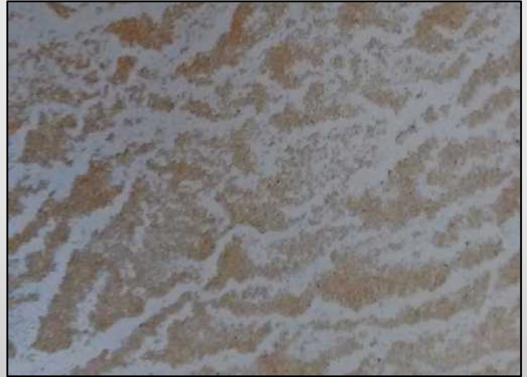
Partículas retenidas en la segunda filtración realizada con malla estándar Partículas > 45 micras
