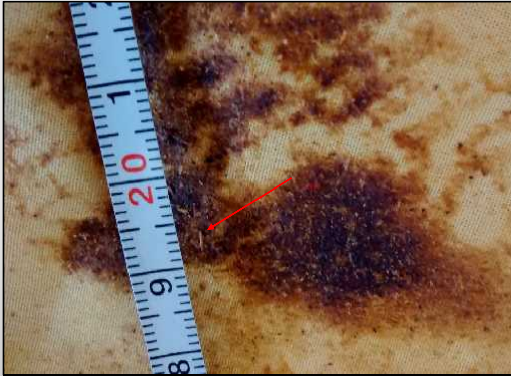
Partículas retenidas en la primera filtración realizada con tela organza Partículas > 120 micras
